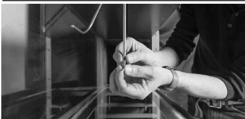
Numérisation de la surface saline d'efflorescences à l'aide d'un scanner 3D à lumière structurée. Les chercheurs reproduisent en laboratoire les conditions de formation des efflorescences, ces dépôts blanchâtres qui recouvrent parfois les murs de bâtiments anciens et de caves. Il s'agit de preuves d'une infiltration par l'eau qui, après s'être évaporée, laisse en surface, sous forme de cristaux, le sel dont elle était chargée. Les chercheurs étudient ces efflorescences pour trouver des moyens de préserver les fresques murales qui recouvrent parfois les murs. © Cyril FRESILLON/IMFT/CNRS Photothèque
